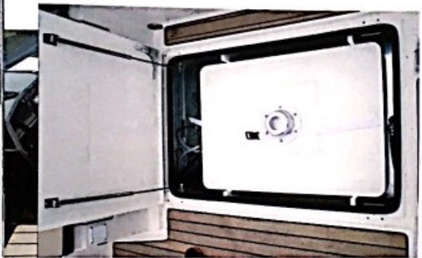
▲ Spremnik goriva Ispod podnice u kokpitu je spremnik goriva od 207 litara. Iznad njega još ima mjesta za ploču stola koja se montira iznad podnice
