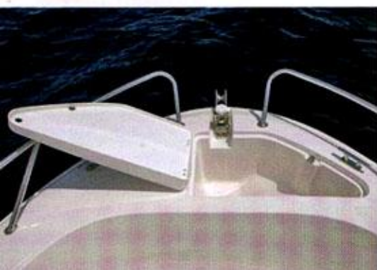
▲ Vodilica za sidro ulazi izravno u spremište za lanac i konop u vrhu pramca
