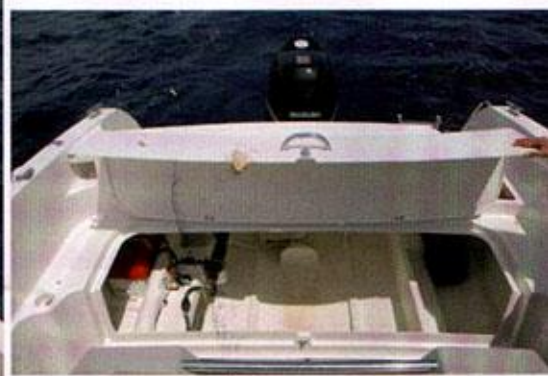
▲ Spremište Podizanjem gornje plohe krmene klupe otvara se pristup velikom spremištu
