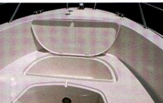
▲ Malo spremište s poklopcem unutar klupe
